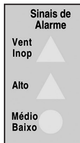
Fig. 4-7 Aspecto do setor de Alarm Signals onde se acham os indicadores luminosos de alarmes.
