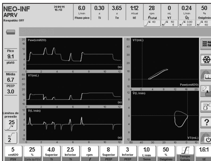
Fig. 10-16 Imagem de uma tela de ventilação APRV. Na imagem se pode observar que durante o primeiro período de PEEP superior se efetuaram duas respirações espontâneas, enquanto no seguinte período de PEEP inferior está desenhada outra respiração espontânea.
