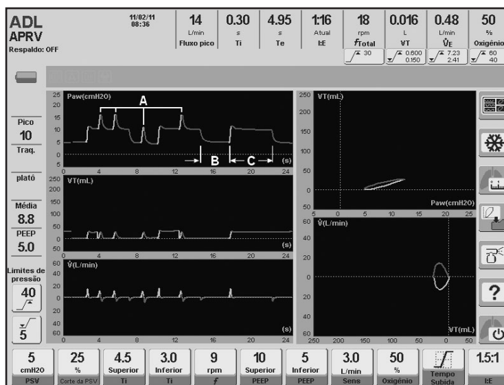
Fig. 9-31 Tela com curvas padrão em modo APRV. Simularam-se respirações espontâneas durante PEEP superior e inferior (A) e deixou-se um período de PEEP inferior (B) e um de PEEP superior (C) sem respirações acopladas.
