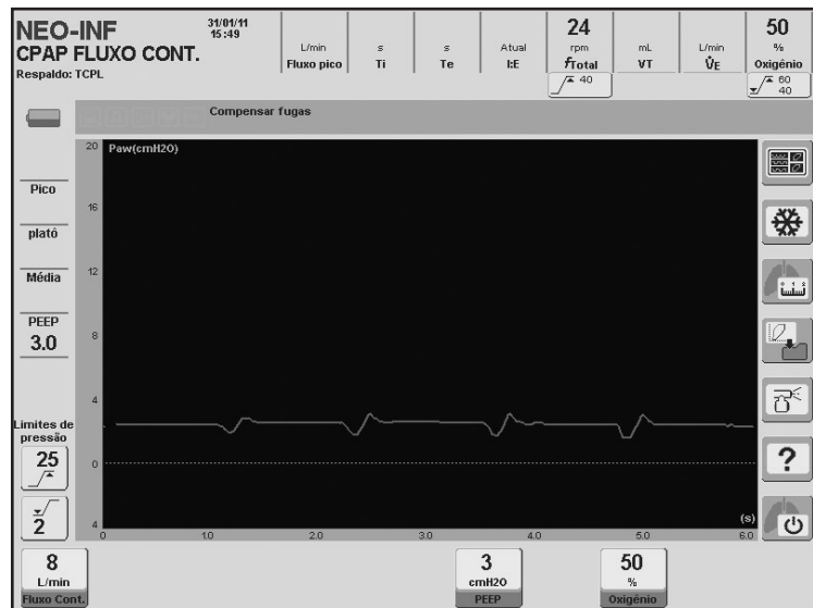
Fig. 10-23 Curva de pressão predeterminada em CPAP fluxo contínuo
