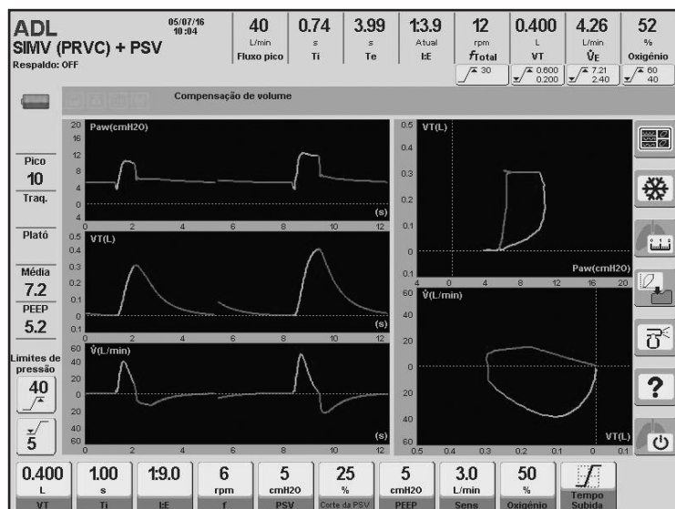
Fig. 9-22 Modo SIMV (PRVC) + PSV. Imagem capturada durante ventilação em categoria ADL. (A) Respiração mandatória PRVC, e (B) respiração espontânea com pressão de suporte.
