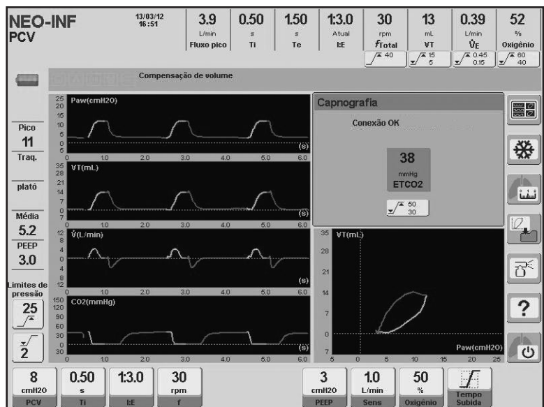
Fig. 14-3 Tela de CAPNOGRAFIA em categoria paciente ADL. incorpora duas curvas e uma folha de dados monitorados. Abaixo: Tela de CAPNOGRAFIA em categoria paciente NEO-INF
