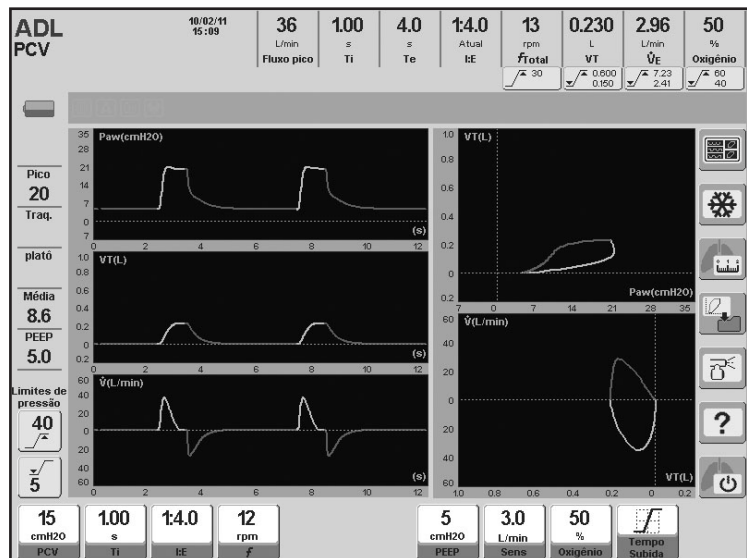
Fig. 9-4 Tela principal de CINCO CURVAS durante ventilação em modo PCV
