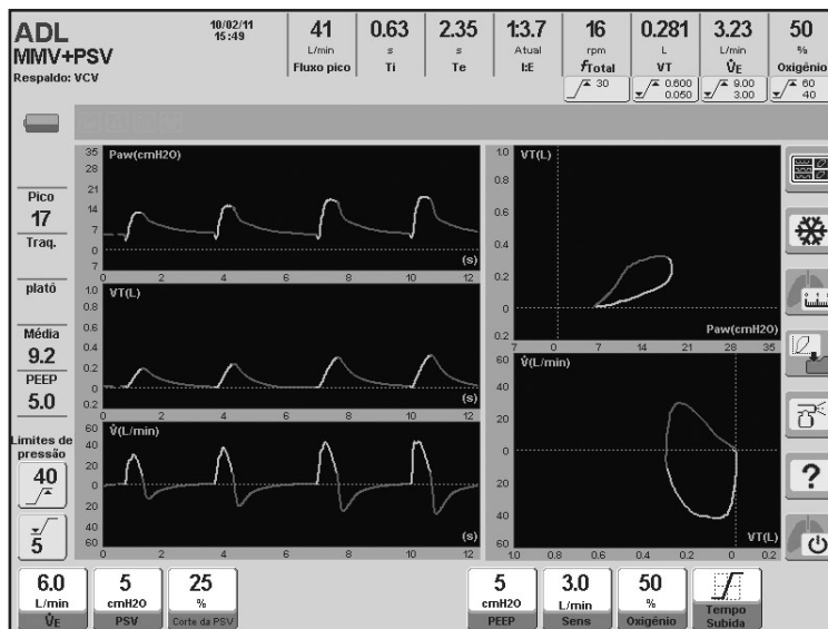
Fig. 9-25 MMV + PSV. A imagem mostra um caso em que o volume minuto objetivo foi cumprido e por isso o nível de PSV se manteve constante nas três respirações observadas.
