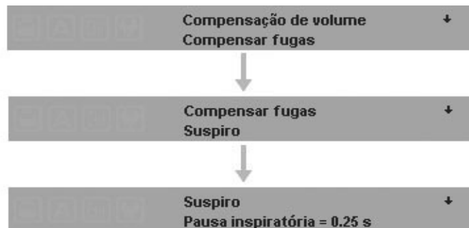
Fig. 4-5 As três barras mostram a sequência de mensagens, quando ativas as funções de Compensação de volume, Compensação de fugas, Suspiro, e Pausa inspiratória.
