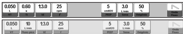
Fig. 9-3 Imagem dos controles habilitados em VCV, categoria PED. Mostram-se com os valores predeterminados para cada um deles. Na parte superior: Ajuste de VT+Ti. Na parte inferior: Ajuste de VT+Fluxo.
