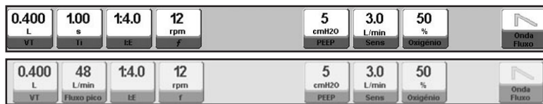
Fig. 9-2 Imagem dos controles habilitados em VCV, categoria ADL. São apresentados os valores padrão para cada um deles. Na parte superior: Ajuste de VT+Ti. Na parte inferior: Ajuste de VT+Fluxo.
