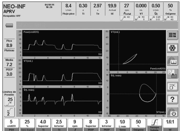
Fig. 10-17 Imagen de una pantalla de ventilación APRV en NEO-INF. En la imagen se puede observar que durante el primer período de PEEP superior se han efectuado dos respiraciones espontáneas, mientras que en el siguiente período de PEEP inferior se encuentra graficada otra respiración espontánea.
