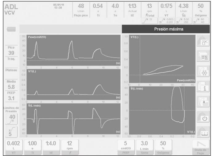
Fig. 4-6 Imagen en la cual se resalta el espacio reservado para la aparición de los Avisos en pantalla de alarmas. En este caso se encuentra activa la alarma de Presión inspiratoria máxima.
