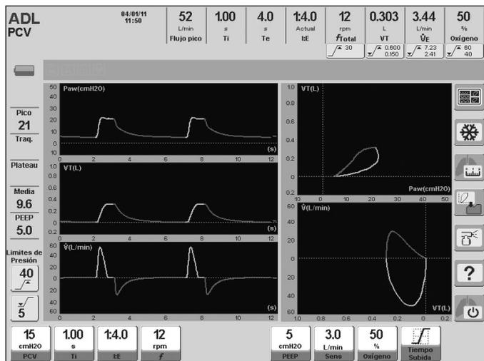
Fig. 9-4 Pantalla principal de CINCO CURVAS durante ventilación en modo PCV
