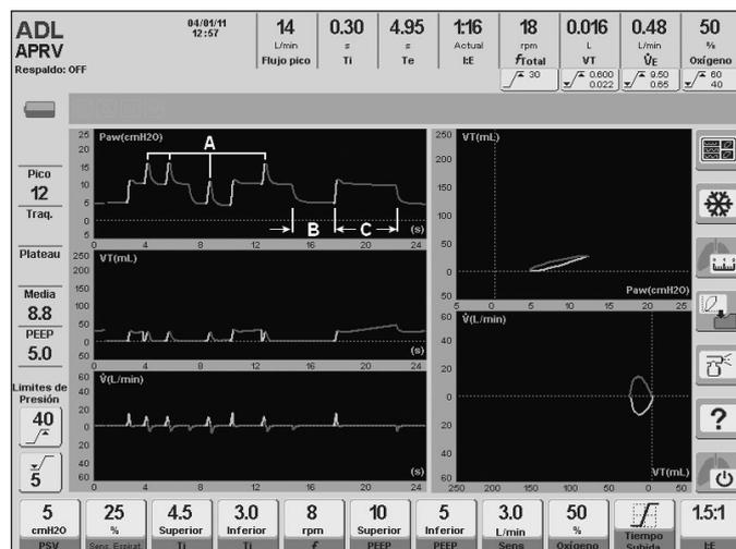
Fig. 9-31 Pantalla con curvas estándar en modo APRV. Se han simulado respiraciones espontáneas durante PEEP superior e inferior (A) y se ha dejado un período de PEEP inferior (B) y uno de PEEP superior (C) sin respiraciones acopladas.
